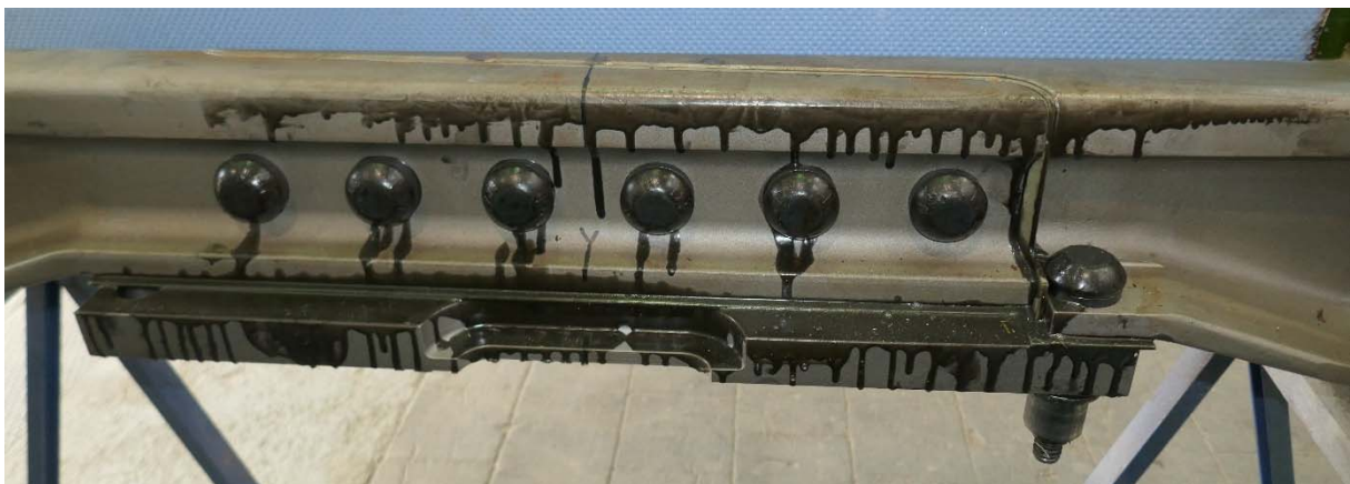
Abbildung 7: Gegenseitige Ansicht der Probe ABJ-009 nach der Dauerfestigkeitsprüfung
