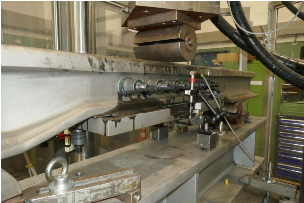
Abbildung 5: Probe ABJ-009 in der Dauerfestigkeitsprüfung
