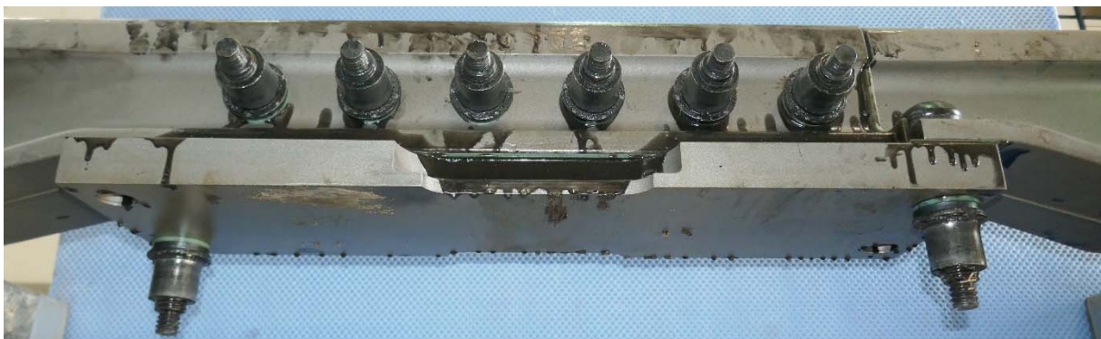
Abbildung 6: Ansicht der Probe ABJ-009 nach der Dauerfestigkeitsprüfung
