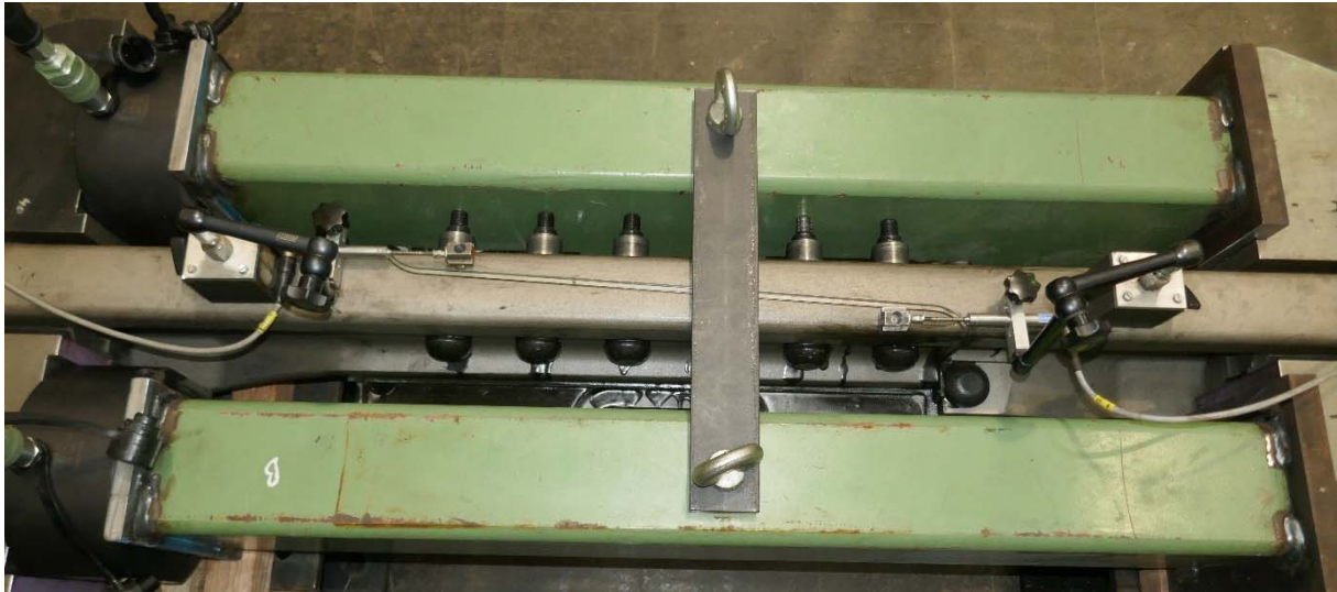
Abbildung 3: Probe ABJ-007 im Prüfaufbau zum Nachweis der Längskraftabtragung
