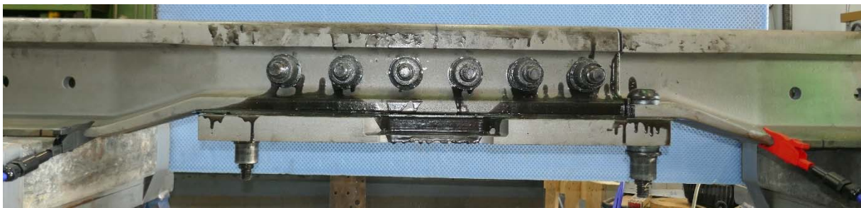
Abbildung 8: Messung des Isolationswiderstandes an ABJ-009 nach der Dauerfestigkeitsprüfung
