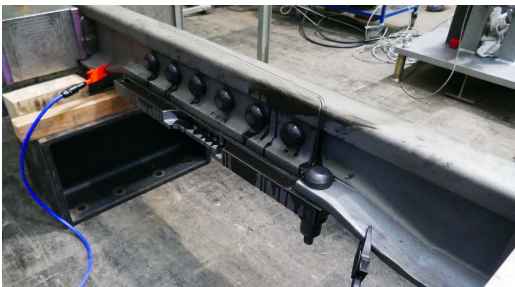
Abbildung 4: Probe ABJ-007 ohne Beschädigung nach dem Zugversuch (während der anschließenden Messung des Isolationswiderstandes)
